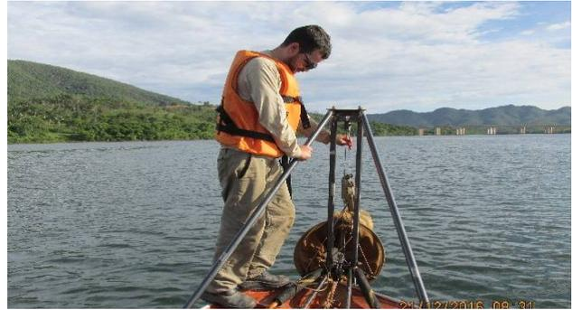
Equipamento utilizado para o içamento da rede de coleta de ictioplâncton
