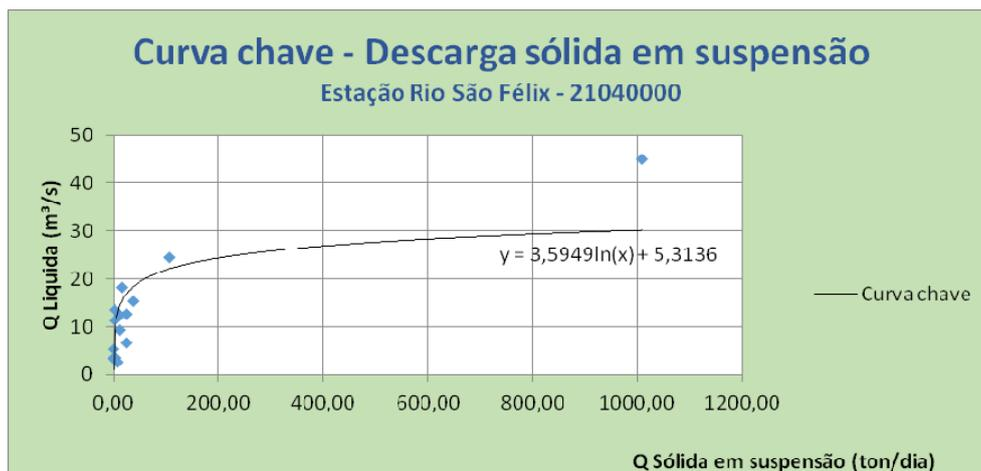
d) Curva Chave Descarga Solida x Descarga líquida
