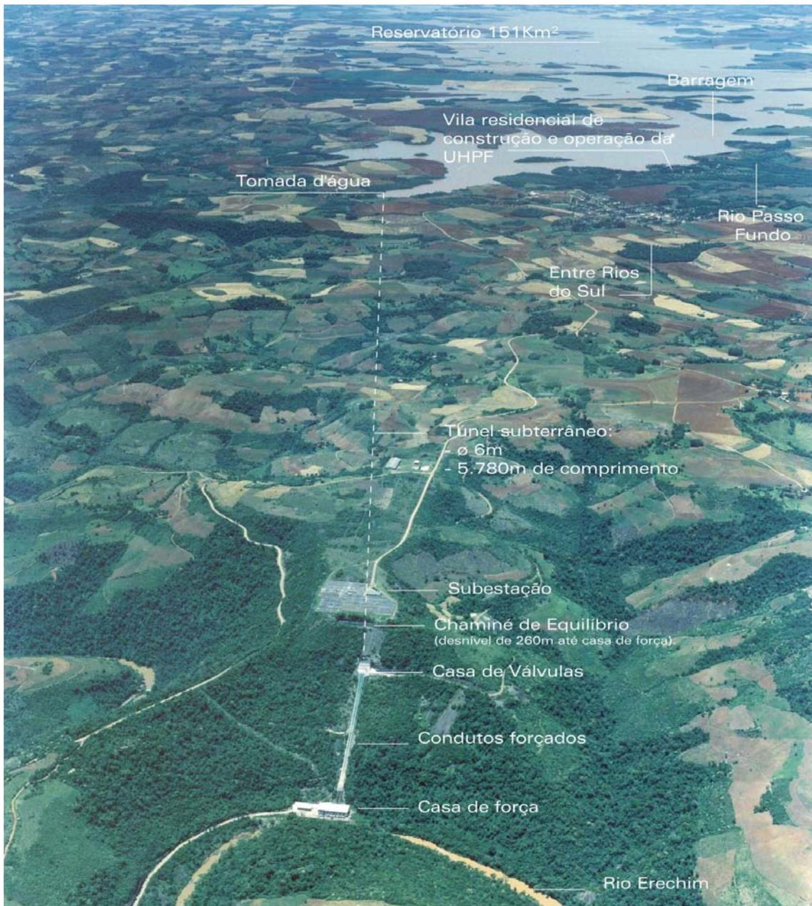
Foto aérea do empreendimento UHE Passo Fundo com indicação das estruturas de geração.
