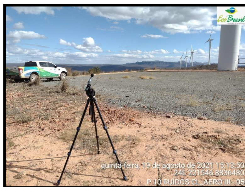
Figura 7. Medidor de pressão sonora utilizado sob o trilho aproximadamente a 1,2m do solo.
