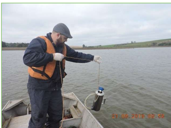
Figura 1.7 - Amostragem dos diferentes níveis verticais com auxílio de Garrava de Van Dorn.
