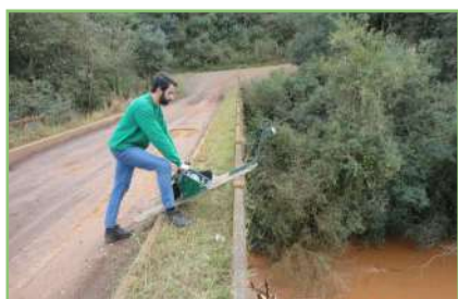
Figura 3.1 - UHE Passo Fundo Montante (Barra do Facão): medição de descarga líquida no dia 29/05/2019.
