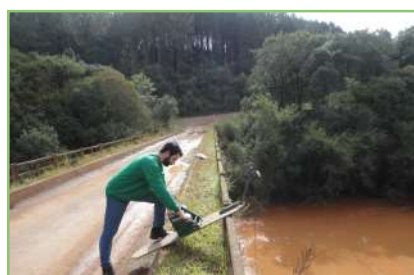
Figura 3.2 - UHE Passo Fundo Montante (Barra do Facão): medição de descarga sólida no dia 29/05/2019
