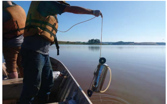
Figura 1.8 - Amostragem dos diferentes níveis verticais com auxílio de Garrafa de Van Dorn.
