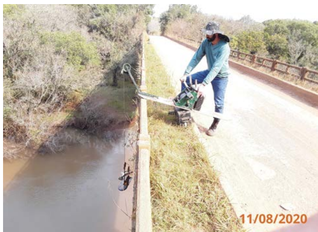
Figura 3.2 – UHE Passo Fundo Montante (Barra do Facão): medição de descarga líquida no dia 11/08/2020
