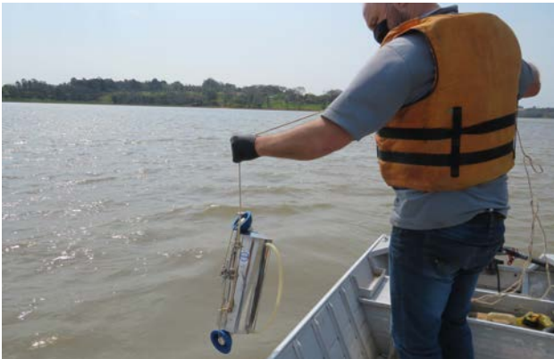
Figura 1.7 - Amostragem dos diferentes níveis verticais com auxílio de Garrafa de Van Dorn.
