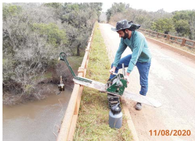
Figura 3.3 – UHE Passo Fundo Montante (Barra do Facão): medição de descarga sólida no dia 11/08/2020
