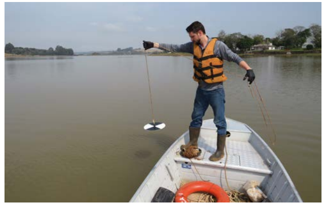
Figura 1.4 – Utilização do disco de Secchi durante o monitoramento das águas superficiais.
