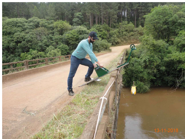
Figura 3.3 – UHE Passo Fundo Montante (Barra do Facão): medição de descarga sólida no dia 13/11/2018.
