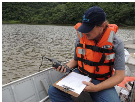
Figura 1.4 - Aferições de parâmetros in loco das águas superficiais da área de influência da UHE Passo Fundo no P04.
