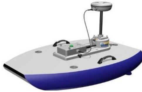
Figura 6 - Representação do Equipamento River Surveyor M9 Montado.
